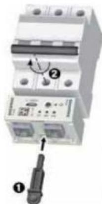
Монтаж на DIN-рейке
